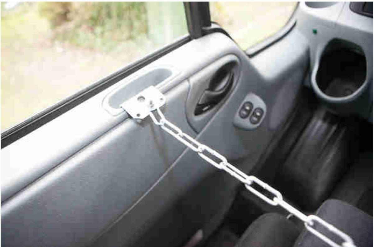
Die Winkel werden nun rechts und links in die Türgriffe gesteckt. Alternativ können sie auch am Fenster eingesteckt werden. Sind beide Winkel eingehängt, kann man mit der Schere die Kette spannen:
