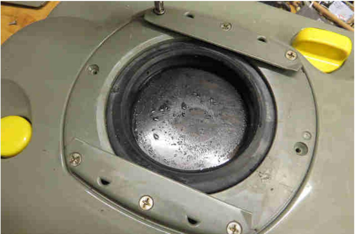
Alle Schrauben entfernen und den Deckel abnehmen.
