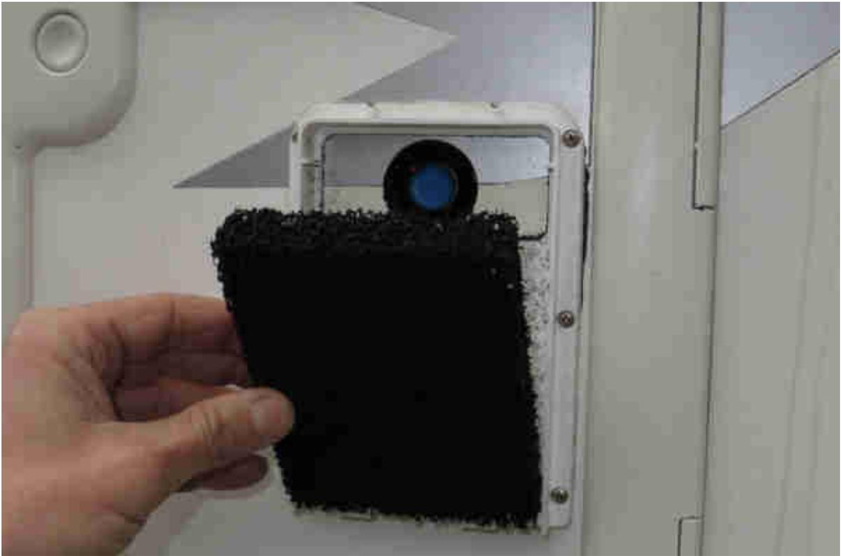
Anschließend die Abdeckung wieder oben einhängen und unten eindrücken, bis man die Schrauben wieder einschrauben kann. Hierbei macht man es sich einfacher, wenn man zu zweit arbeitet.
