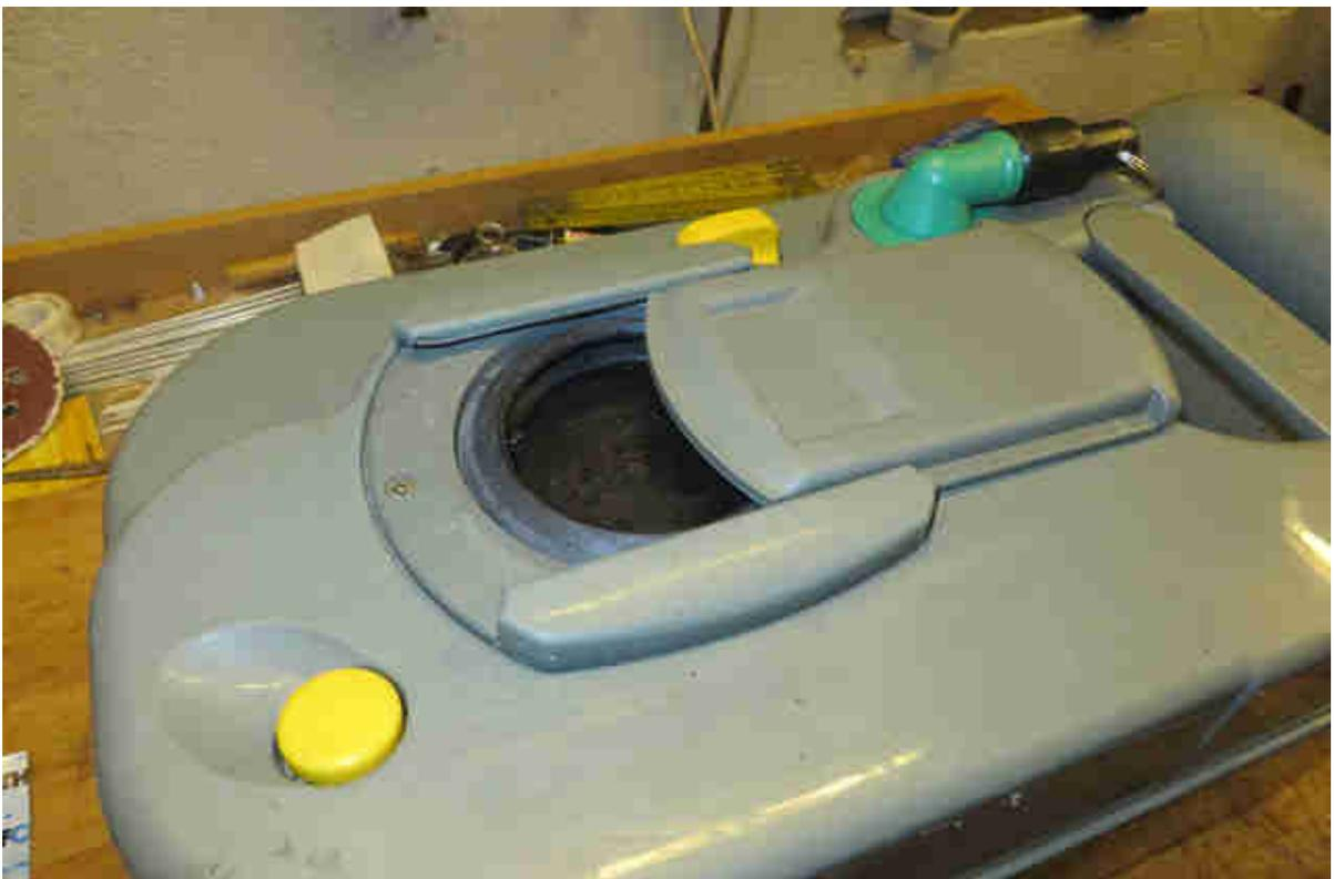
Nun werden die ersten zwei Schrauben sichtbar. Aber aufgepasst. Das ist nicht alles. Keine Gewalt anwenden, nicht versuchen mit einem Schraubenzieher zu hebeln.
