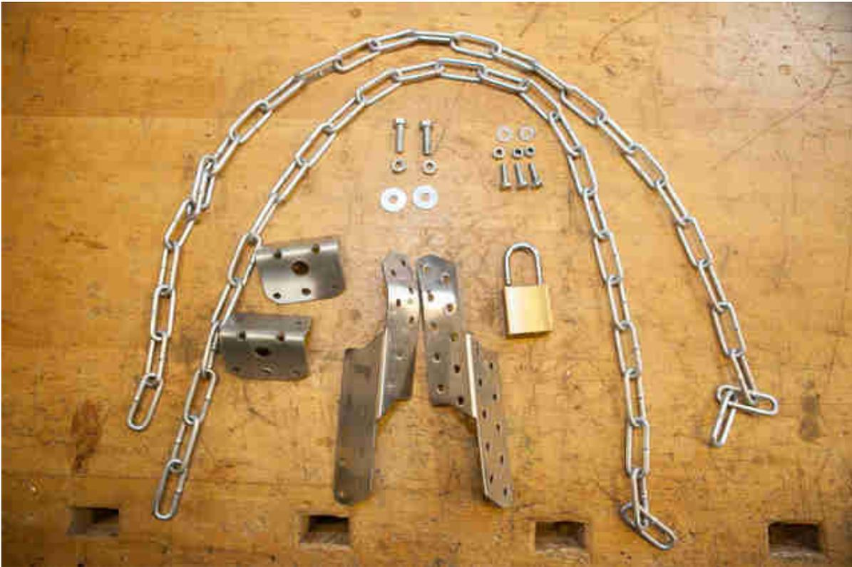
Als erstes werden die Winkel ein Stück gekürzt und am Rand ein Loch mittig gebohrt für die M6 Schrauben. Die Ränder des Winkel sollten mit einer Feile abgerunden und die Kanten gebrochen werden (also angeschliffen). Alles abrunden.
