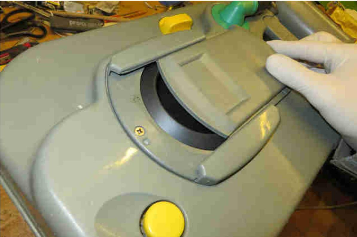
Nach dem Aufstecken der Abdeckung zeigen die beiden Dreiecke auf dem Deckel und der seitlichen Abdeckung zueinander.
