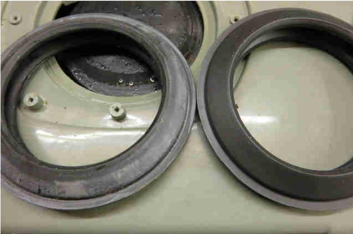
Unter der Dichtung habe ich noch ein wenig den Dreck entfernt und dann die neue Dichtung eingesetzt. Der Schließmechanismus drückt von unten gegen die Dichtung, daher habe ich beim Zusammenbau den Schließer zu Seite geklappt, um die Dichtung mit den Schrauben gleichmäßig festzuschrauben.
