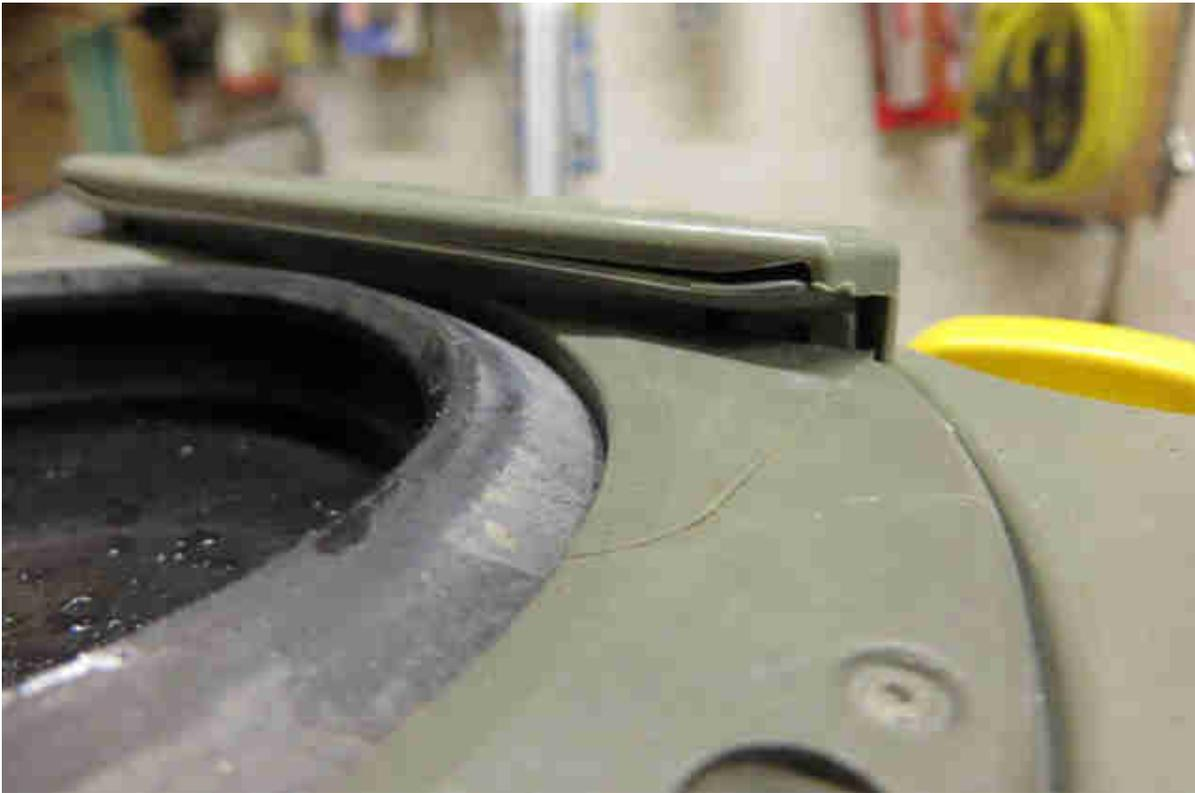
Die seitlichen Halterungen des Schiebers bestehen aus zwei Teilen und es dauerte ein wenig, biss ich verstanden hatte, wie man an die darunterliegenden Schrauben kommt. Ich versuchte zu schieben und zu drücken, aber am Ende erkannte ich den schmalen Spalt.
