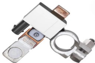
Abb 1: IBS-Stecker am Minus-Pol der Fahrzeug-Batterie
